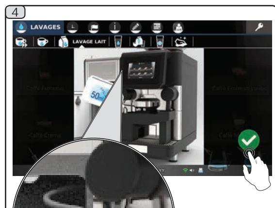
Insérer le tuyau du lait dans le bac.
