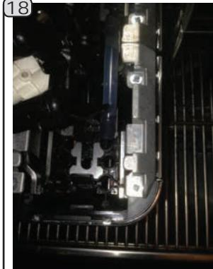
Pousser la fermeture métallique vers l'avant et la retirer.
