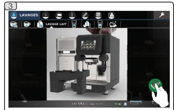
L'écran tactile indique les opérations à effectuer pour l'exécution du lavage lait ; au terme de chaque phase, appuyer sur l'icône .
