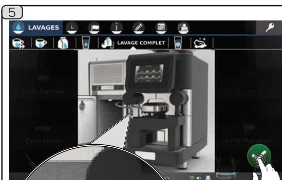
Insérer le tuyau du lait dans le bac.
