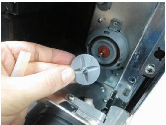
Insérer correctement la roue polarisée (la flèche doit être dirigée vers la partie plate de l'arbre moteur en acier).
