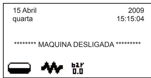
**N.B.:** quando a máquina funciona com acendimento (desligação automático, não utilizar o interruptor geral (23) para desligar a máquina porque nessas condições não é possível o funcionamento do acendimento automático.
