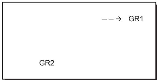
Selektionieren Sie mit den Tasten "+" (30) bzw. **GR1** (Abgabereinheit rechts) oder **GR2** (Abgabereinheit links), und drücken Sie anschließend zur Bestätigung die Taste **PRG** (29).
