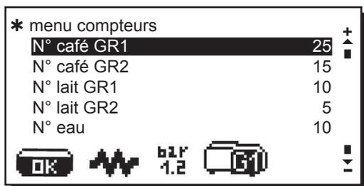
Pour accéder aux différents menus, placer le curseur devant la ligne intéressée, en utilisant les boutons "+" (30) et "-" (31).
