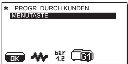
In der unteren Leiste des Displays erscheint je nach der selektionierten Abgabereinheit das Symbol **G1** oder **G2**:
