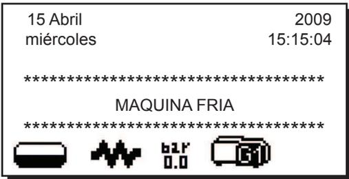
El mensaje "MÁQUINA FRÍA" se alterna a otros eventuales mensajes de aviso (por ejemplo "FALTA CAFÉ SX" o "FALTA CAFÉ DX", etc.).
