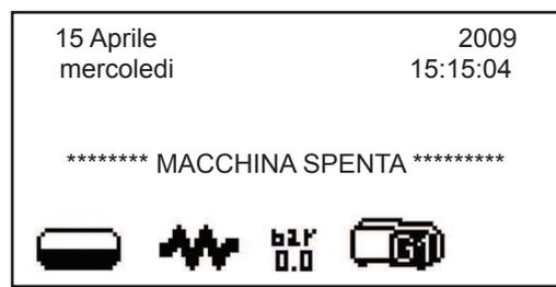
**N.B.:** quando la macchina funziona con accensione/ spegnimento automatico, non utilizzare l'interruttore generale (23) per spegnere la macchina perchè in tale condizione non è possibile il funzionamento dell'accensione automatica.
