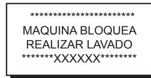
Pulsando la tecla correspondiente al lavado que es requerido en el mensaje (tecla 26 o tecla 28), se realiza el lavado y la máquina se desbloquea.
