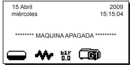
**N.B.:** cuando la máquina funciona con encendido/apagado automático, no hay que utilizar el interruptor general (23) para apagar la máquina, ya que en dicha condición no es posible el funcionamiento del encendido automático.
