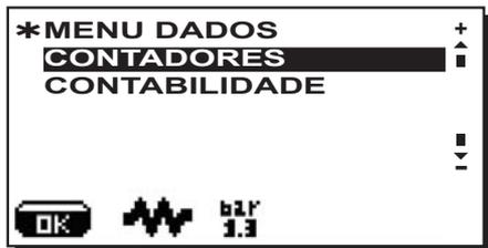
Posicionando o cursor a coincidir com a linha "CONTADORES", através das teclas "+" (30) e "-" (31) e carregando posteriormente na tecla PRG (29),
