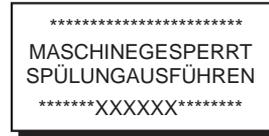
Wenn Sie die Taste des auf der Anzeige geforderten Spülvorgangs drücken (Taste 26 oder 28), wird der gewünschte Spülvorgang ausgeführt und die Maschine entsperrt.
