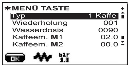
Modifizieren Sie die Anzeige bzw. den angezeigten Wert über die Pfeiltasten „+“ (30) bzw. „-“ (31).
