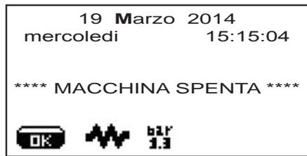
**N.B.:** quando la macchina funziona con accensione/spegnimento automatico, non utilizzare l'interruttore generale (23) per spegnere la macchina perchè in tale condizione non è possibile il funzionamento dell'accensione automatica.
