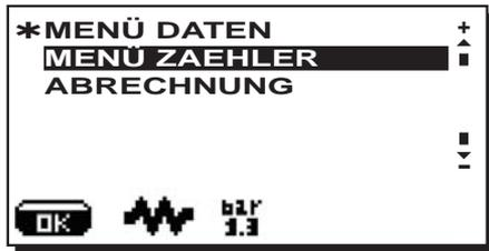
Bringen Sie den Cursor über die Pfeiltasten "+" (30) bzw. "-" (31) auf die Zeile "ZÄHLER", und drücken Sie anschließend die Taste PRG (29); auf dem Display
