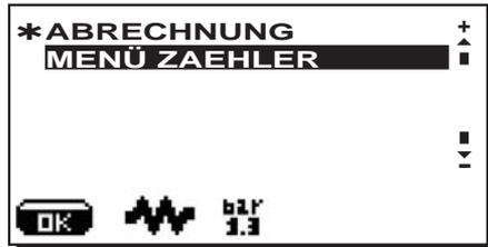
Drücken Sie erneut die Taste PRG (29), auf dem Display werden die Anzahl der insgesamt ausgeführten Abgabevorgänge sowie die Anzahl der Abgabevorgänge pro Wahl taste angezeigt:
