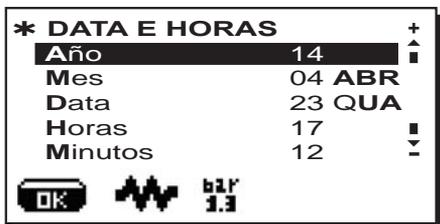
Deslocar o cursor (linha preta) a coincidir com a rubrica a modificar, utilizando as teclas "+" (30) e "-" (31) e depois carregar na tecla **PRG** (29); o cursor torna-se → sendo possível variar o valor da rubrica seleccionado sempre através das teclas "+" (30) e "-" (31).
