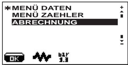
Bringen Sie den Cursor auf die Zeile "ABRECHNUNG" und drücken Sie die Taste PRG (29); auf dem Display wird folgende Meldung ausgegeben:
