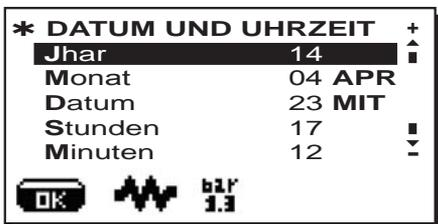
Bringen Sie den Cursor (schwarze Linie) über die Pfeiltasten "+" (30) bzw. "-" (31) auf die zu modifizierende Zeile, und drücken Sie anschließend die Taste PRG (29). Die Darstellung des Cursors ändert sich von → um anzuzeigen, daß nun über die Pfeiltasten "+" (30) bzw. "-" (31) der Wert der selektionierten Zeile modifiziert werden kann. Drücken Sie nach Ausführung der Modifikation zur Bestätigung des eingegebenen Wertes die Taste (31).
