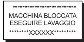
Premendo il tasto corrispondente al lavaggio che viene richiesto nel messaggio (tasto 26 o tasto 28), viene eseguito il lavaggio e la macchina viene sbloccata.
