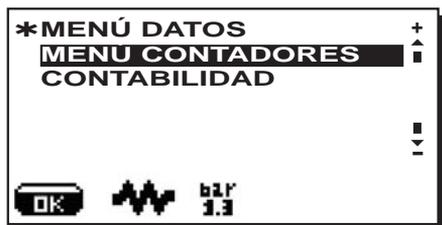
Colocando el cursor en correspondencia de la línea "CONTADORES" a través de las teclas "+" (30) y "-" (31) y pulsando sucesivamente la tecla PRG (29),
